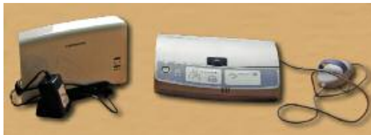
Patienten bekommen Geräte wie diese mit nach Hause. Sie kontrollieren die Funktion von Herzschrittmachern bzw. Defibrillatoren.
